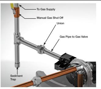
PRESSURE TESTING THE GAS SUPPLY SYSTEM
